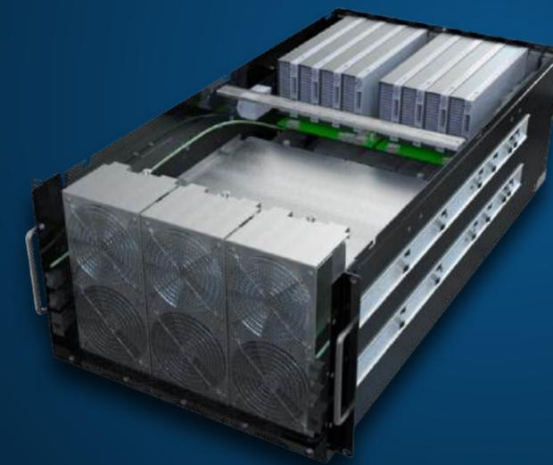
6U Gen 5 PCIe-Erweiterung (bis zu 16 Double-Width GPUs)
